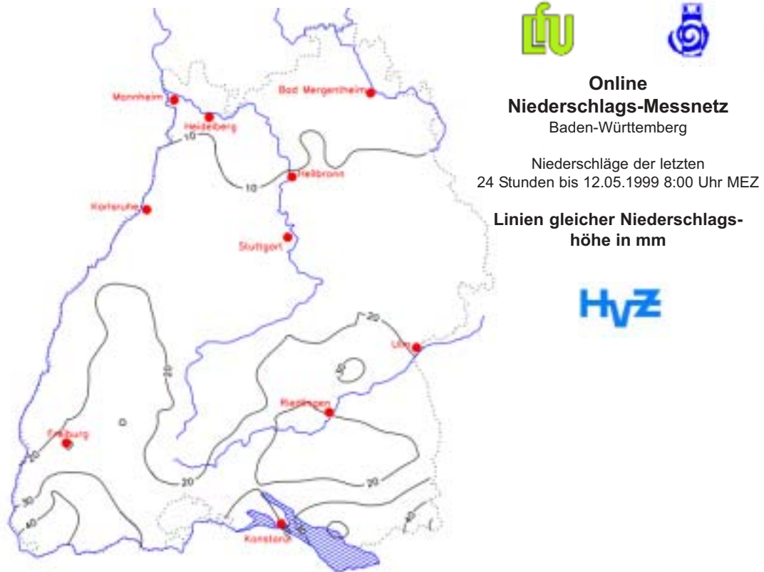
Abb. 7: 24-Std.-Niederschlagsgleichen vom 11.05.1999 8:00 Uhr - 12.05.1999 8:00 Uhr MEZ für Baden-Württemberg; Datenbasis: H ochwasser V orhersage Z entrale Karlsruhe
